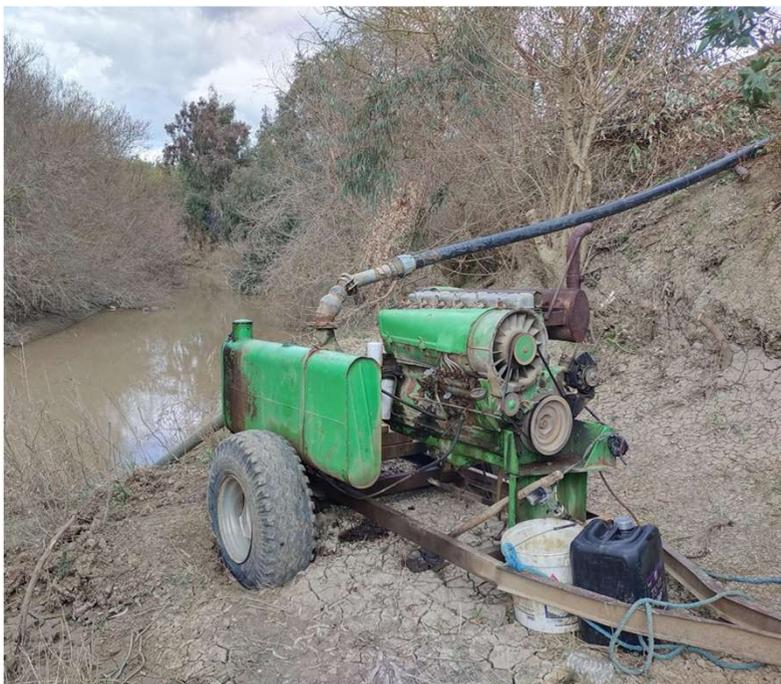
Pompage d'une rivière grâce à un moteur de moissonneuse batteuse à Jendouba
