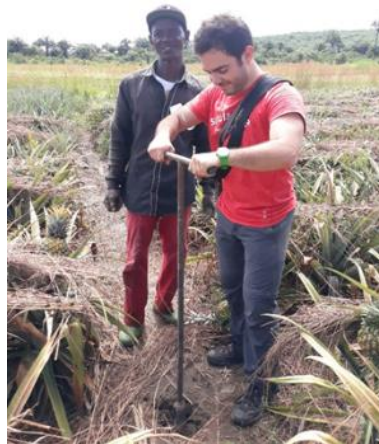
Figure 15 : Prélèvements de sol à la tarière. Source : auteurs, 2021.
