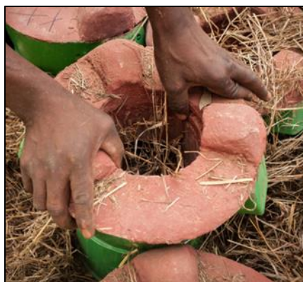
Figure 12 : Exemple de modèle faible coût à bois développé pour les zones rurales au Kenya (projet Hifadhi)
