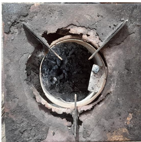
Figure 34 : plaque supérieure corrodée au contact des flammes en sortie de chambre de combustion (Auteurs, 2021)
