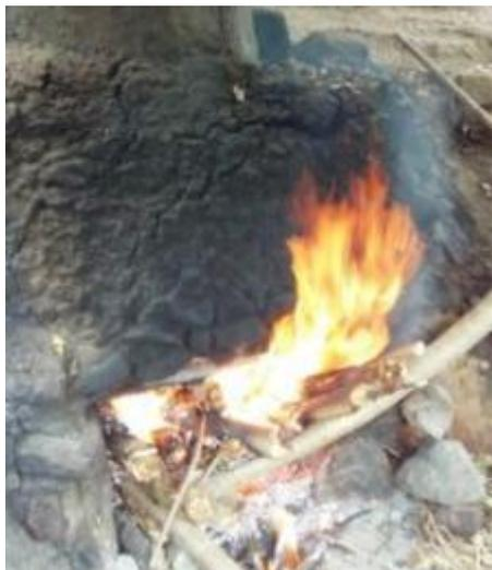
**Foyer de combustion sans grille** placé sous la cuve.
