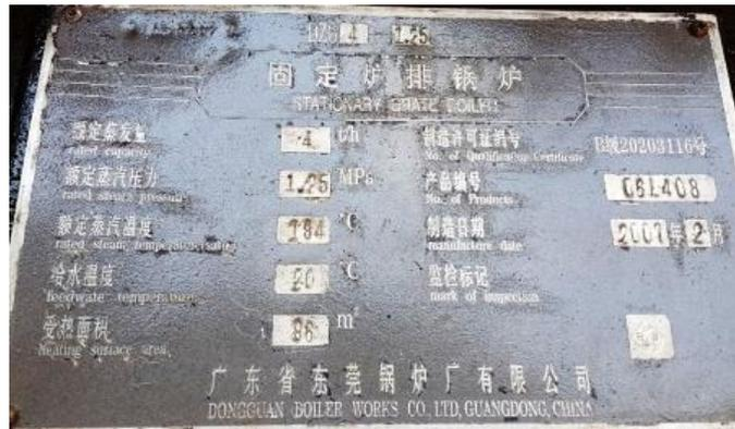
Modèle 4t/h fabriqué en Chine. Ventilateur pour injection air comburant sous la grille stationnaire.
