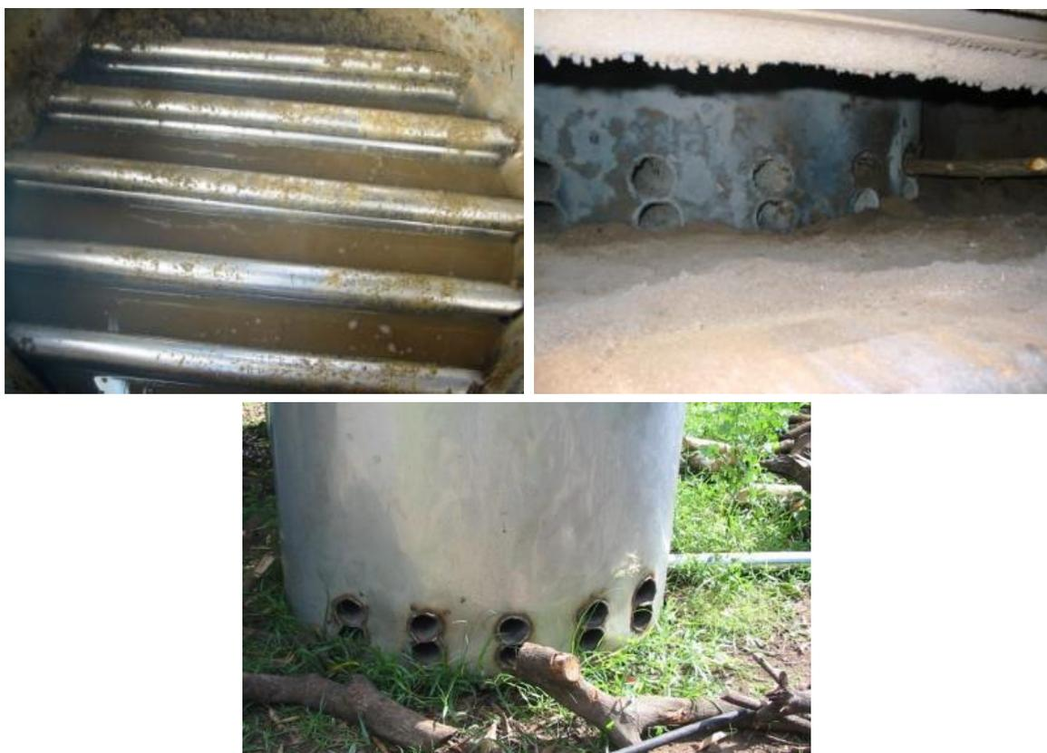
Figure 12. Tubes échangeurs soudés en partie basse de cuve aux Comores (Source : AUTEUR, 2019)
