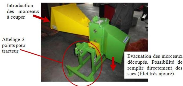
Modèle de recoupeuse robuste (prix usine 800 €) pour la préparation de bois d'élagage (diamètre maxi de 10 cm) pouvant être utilisée efficacement dans des chambres de combustion adaptées aux palets compressés (conditionnement et séchage facilités)
