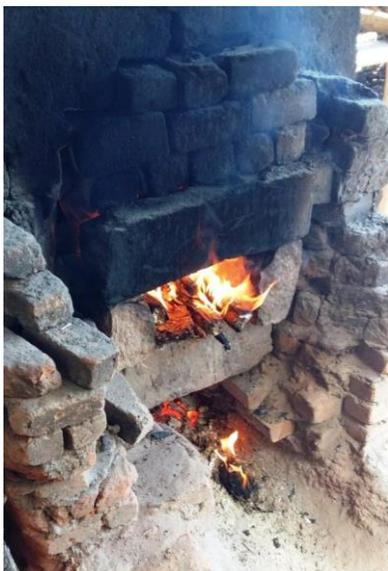
Foyer de combustion bois bûche construit en briques terre cuite en partie basse de la chaudière vapeur.
