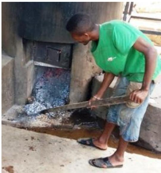
La mauvaise conception des grilles entraîne une chute de braises qui s'accumulent. Ce problème d'accumulation de braises peut aussi se produire par un mauvais réglage d'air primaire sur des chambres de combustion plus avancées.
