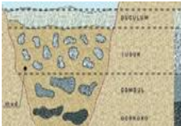
Figure 13 - Coupe schématique d'une mare à natron profond (Source : Bouquet, 1990) 42
