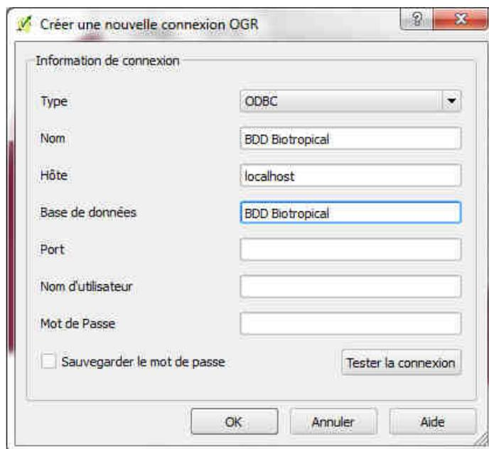
Figure 66 - Remplissage de l'outil de création d'une nouvelle connexion
