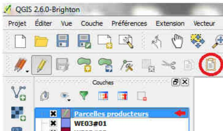
Figure 57 - Bouton pour le collage des polygones et couche de destination sélectionnée, en mode édition
