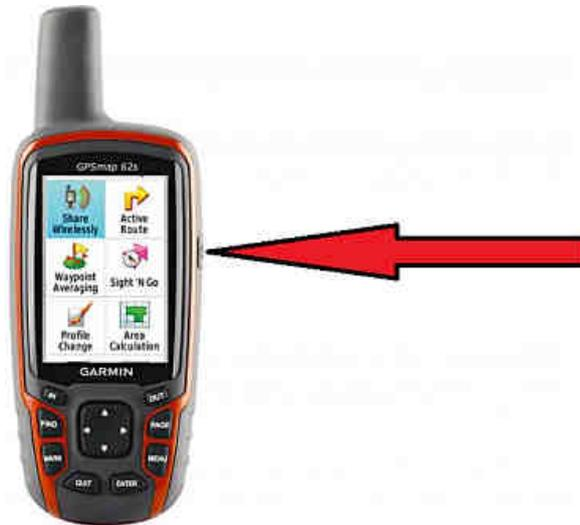
Figure 27 - Localisation du bouton permettant d'allumer et éteindre le GPS
