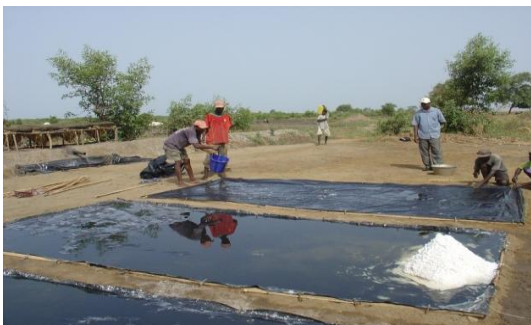
5. Epannage de la saumure sur les bâches
